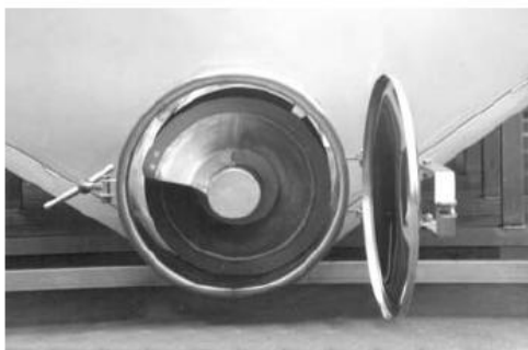
Detalle Puerta de descarga
