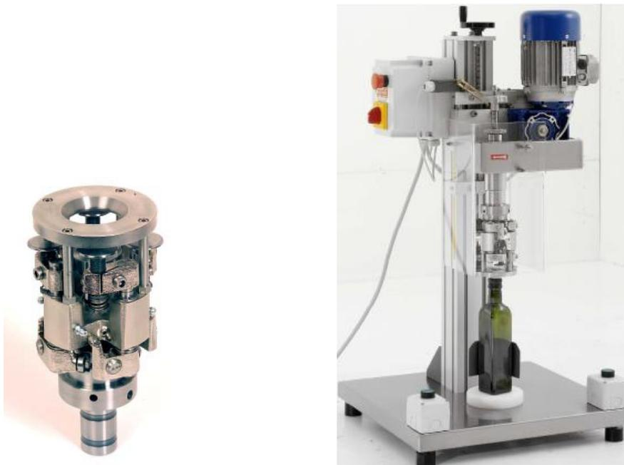
El operario debe posicionar la botella en el platillo manualmente, entre unas guías de sujeción para tal fin, pulsar el botón que pone en marcha las rulas roscadoras y accionar el pulsador para que el cabezal baje hacia la botella, en pocos segundos el cabezal roscador termine el cierre.
