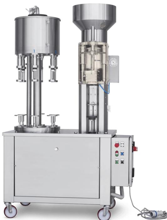
Maquina semiautomática compuesta por llenadora rotativa de 6 grifos de llenado por gravedad, fabricada en acero inoxidable y materiales de tipo alimentario, con alimentación manual y levantamiento y llenado de las botellas automático. Variador electrónico de velocidad.
