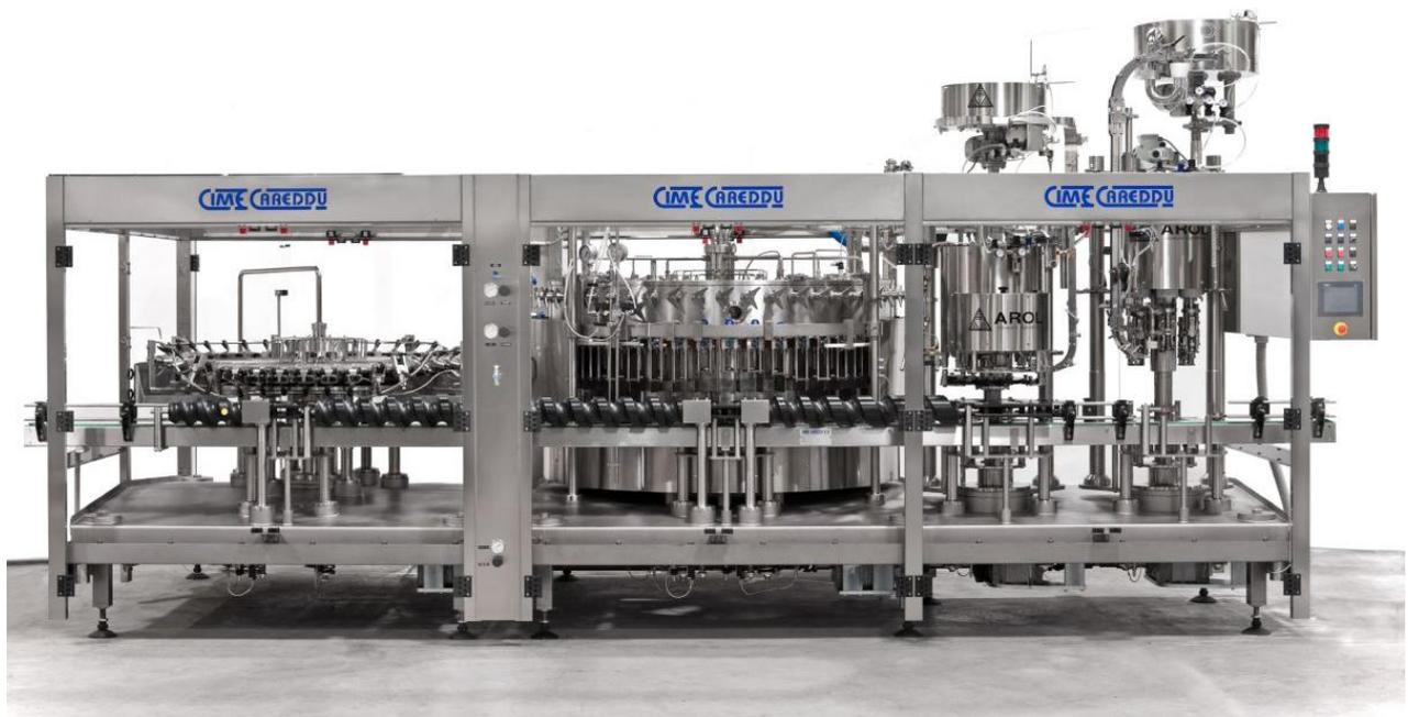
El tanque de llenado situado en la parte superior de la máquina está dotado de una válvula automática de entrada de producto comandada por sondas de nivel máximo y mínimo.
