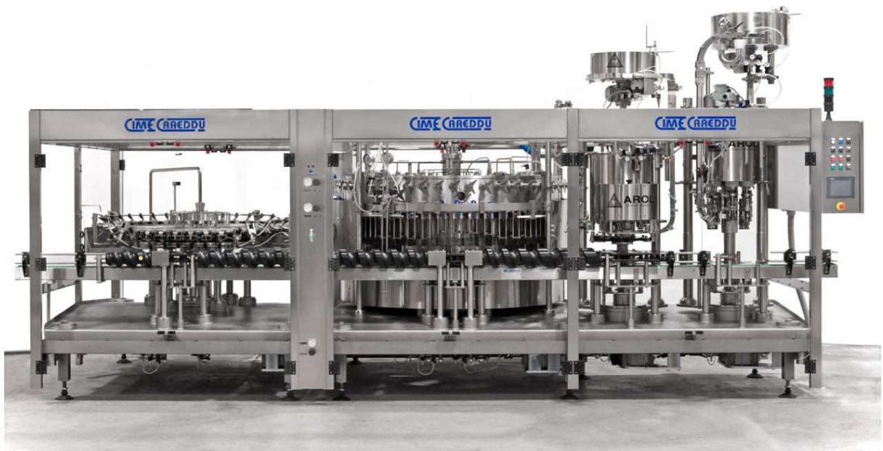
El tanque de llenado situado en la parte superior de la máquina está dotado de una válvula automática de entrada de producto comandada por sondas de nivel máximo y mínimo.
