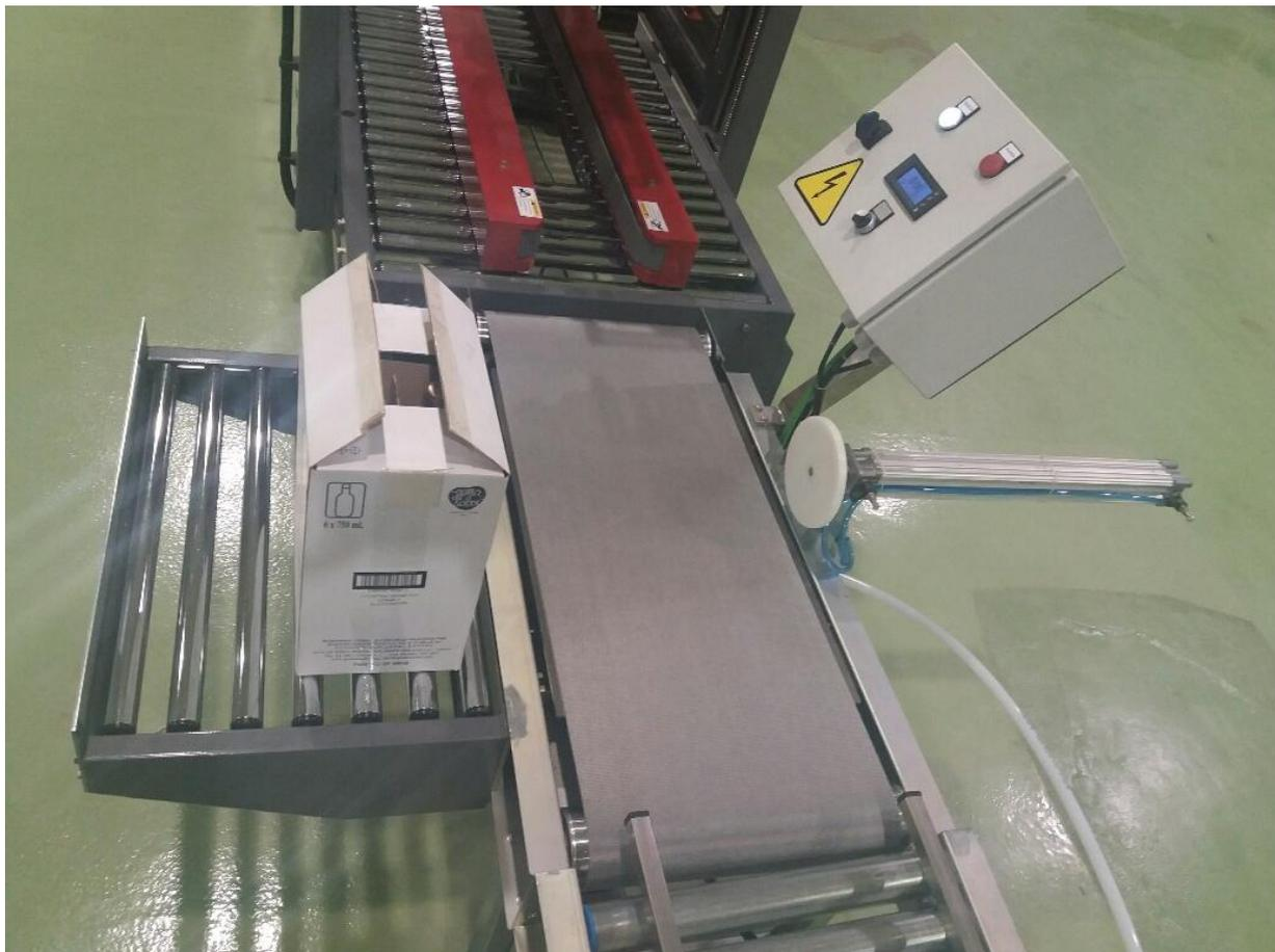
Sistema de control de peso para caja llena, compuesto por los siguientes elementos:
