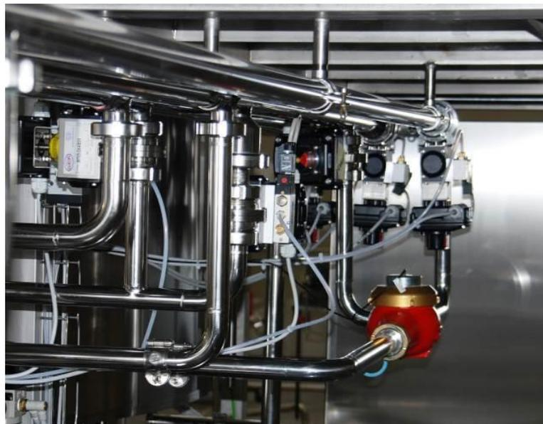
El equipo puede administrar en modo automático todos los procesos: maceración, lectura de los niveles, proceso durante la filtración y expulsión de malta agotada al exterior, ebullición, whirlpool, los trasiegos entre las cubas, las ordenes para la gestión del circuito de distribución de vapor, la válvula de mezcla del agua (proceso, sparging y los lavados), en definitiva, se tratar de una planta con gestión totalmente automatizada.
