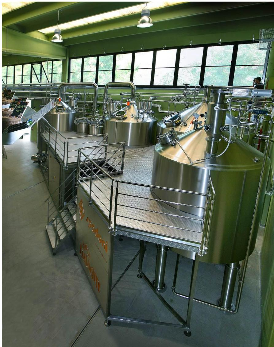
Sala de cocción para la producción de 6.000lts de mosto de cerveza terminado, con sistema de 4 depósitos, todos isotérmicos, con 4 de ellos calentados. Equipo optimizado para producción de 15° Plato. La filosofía de diseño es el "cuatro tanques" con las etapas de "Maceración" (Tanque 1) y "Filtración" (Tanque 2), "Ebullición/Whirlpool" (Tanques 3 y 4), con hervidor externo para optimizar costes energéticos y tiempos de producción.
