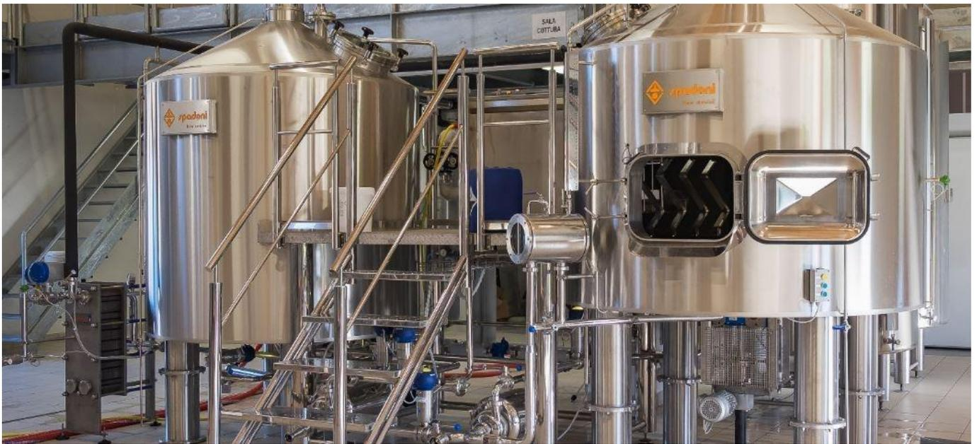
Sala de cocción para la producción de 2.500lts de mosto de cerveza terminado. Equipo optimizado para una solicitud de entre 12 y 16° Plato. La filosofía de diseño es el "dos tanques" con las etapas de "Maceración/Filtración" (Tanque 1) y de "Ebullición/Whirlpool (Tanque 2).
