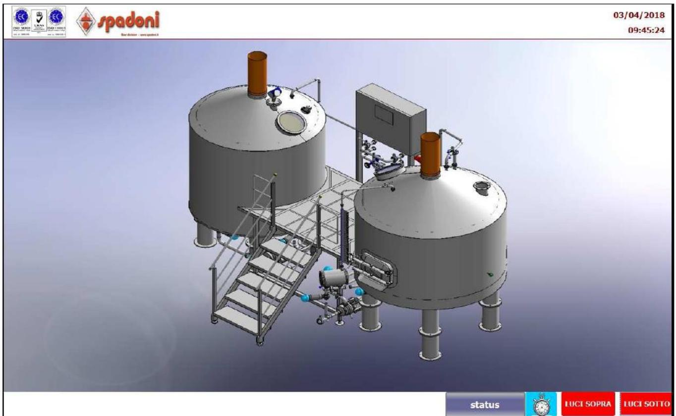
Posibilidad de controlar válvulas y motores de solenoide para hacer transferencias entre diferentes tanques, o cualquier otra operación rápidamente gracias a la imagen sinóptica
