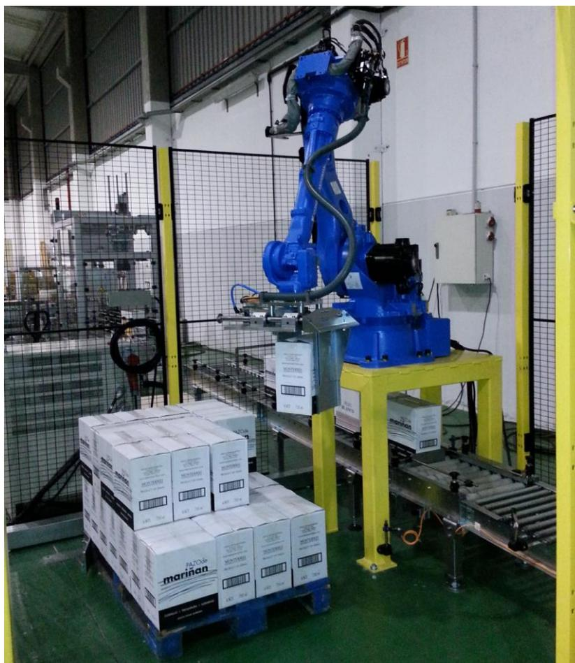
Celda de paletizado automático, compuesta por Robot antropomórfico, transporte de cajas y valla de protección con seguridades según normativa CEE.
