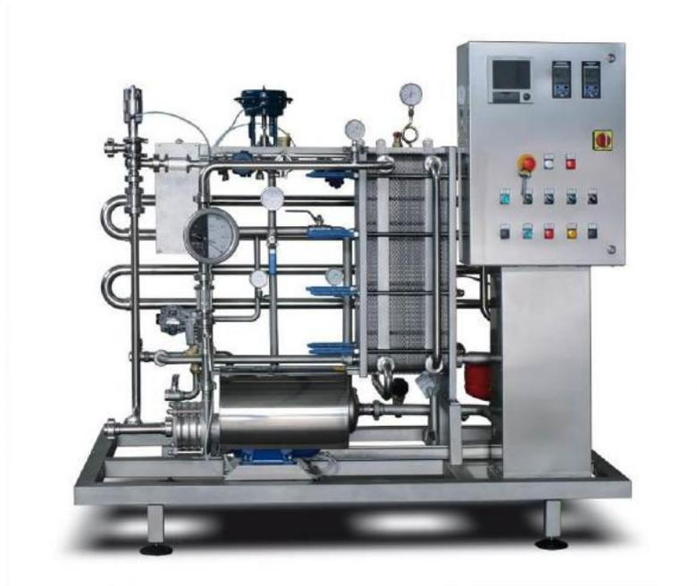
Unidad para el tratamiento de 800 lt / h de cerveza con control automático de la temperatura de pasteurización y enfriamiento.
