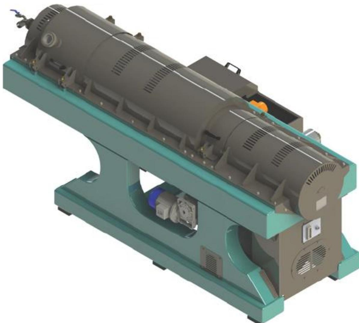
Los decanter horizontal **Modelo TL-2000** han sido diseñados para trabajar pastas de aceituna a bajas temperaturas y están equipados con dos o tres salidas: para aceite, agua y orujo. La adición de agua extraída varía de 0 a un máximo del 20% para tres salidas.
