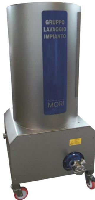
El grupo de lavado está dotado de un flotador mecánico a la entrada del agua, de una bomba centrífuga de lavado y de una bomba de rotores flexible de goma para la recuperación del lavado.
