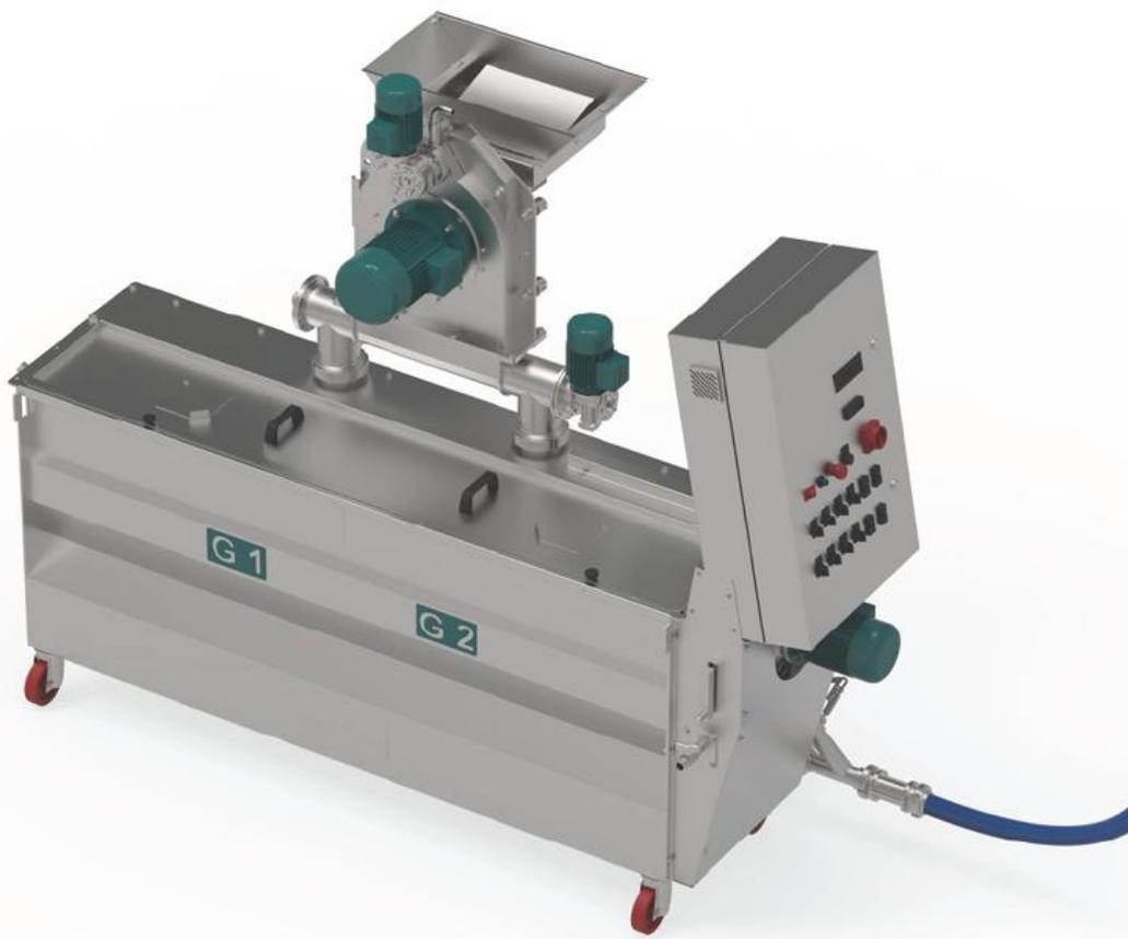
El batido se realiza en batidoras cerradas para evitar la oxidación en la masa de aceituna y asegurar un control eficaz de la temperatura. La entrada de la pasta en el **Modelo 2GL** es mediante sinfín distribuido a las dos batidoras, desde el triturador **Modelo FR** instalado en su parte superior, con distribución de la masa de aceituna, a izquierda y derecha. La limpieza se facilita gracias a la abertura total de la tapa superior, de esta manera no quedan residuos del proceso de elaboración.
