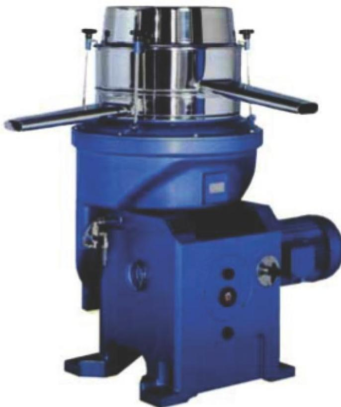
Separadora centrifuga vertical para la clarificación del aceite, eliminando las partículas solidas y residuos de agua. El separador está dotado de un sistema electrónico que manda la fase de arranque al control de la velocidad; además viene equipado con discos de diferentes tamaños para la separación de la fases y de un sistema automático de descarga de residuos.
