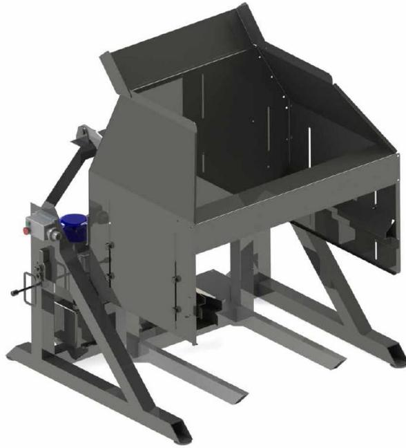
El elevador/volteador de palots sirve para el vaciado de las aceitunas en la tolva de la almazara. El palot se posiciona por encima del elevador/volteador por medio de una transpaleta. El equipo está dotado de una centralita hidráulica que acciona un pistón; el pistón eleva la caja hasta vaciarla completamente. Como máximo puede elevar un palots con un peso total de 500 Kg.
