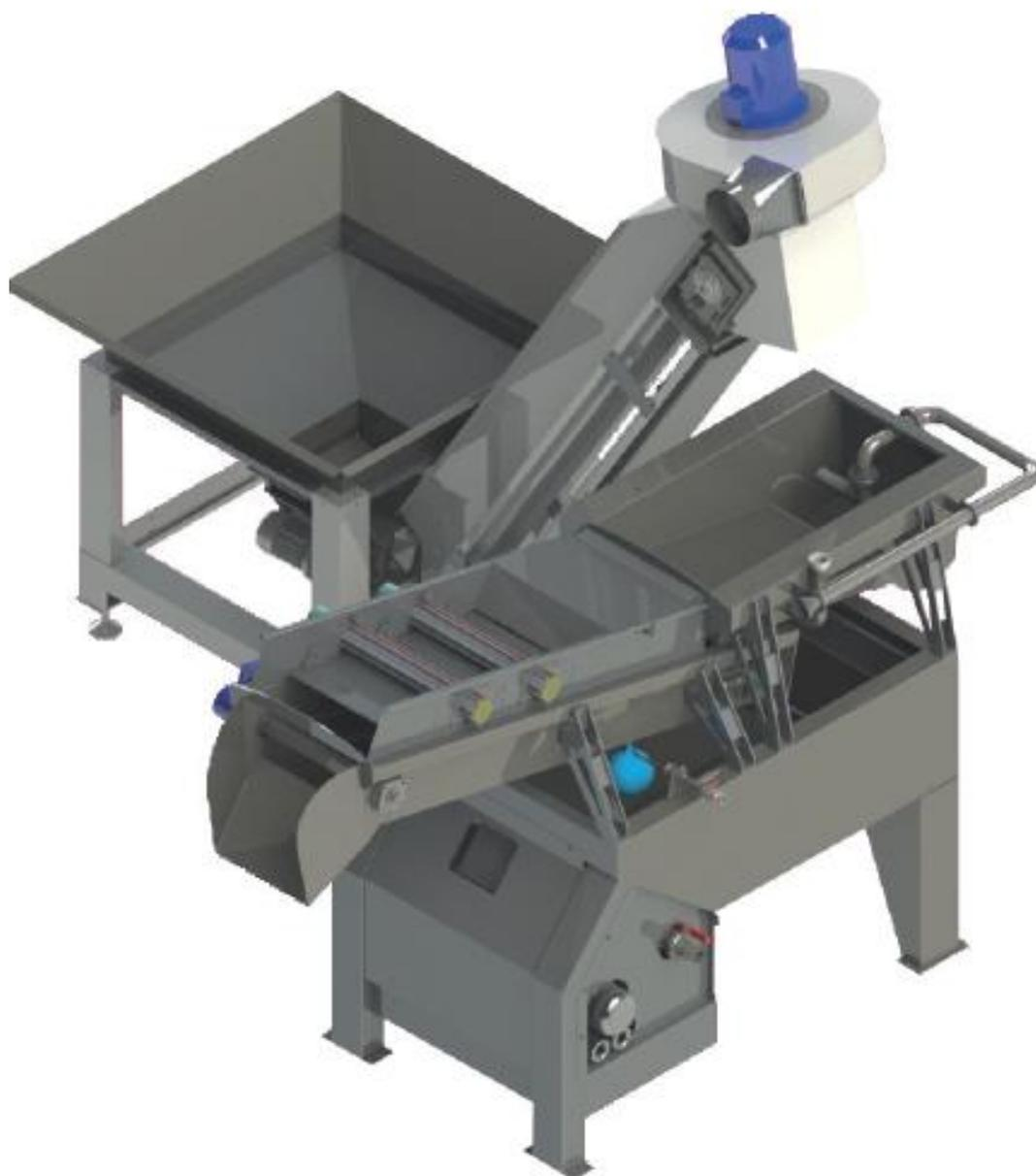
El grupo compacto para deshojado y lavado de aceitunas, **Modelo DLE SUPER\_T**, consta de un elevador de cinta con tolva para la recepción de 400 Kg. de aceitunas; la tolva está dotada de vibrador y dosificador con variador de velocidad, necesario en caso de aceitunas muy sucias.
