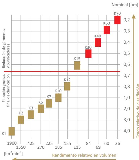
Condiciones:  $\Delta p$  - 100kPa (1bar), Medio: agua a 20°C.
