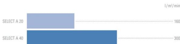
Condiciones:  $\Delta p = 100 \text{ kPa}$ , medio: agua a  $20 \text{ }^\circ\text{C}$
