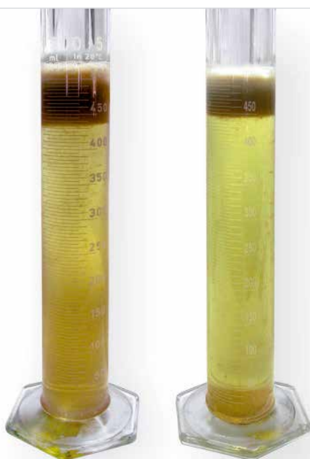
Figura 1: Mosto testemunha e mosto tratado com 10 g/hl de Proveget FLOT
