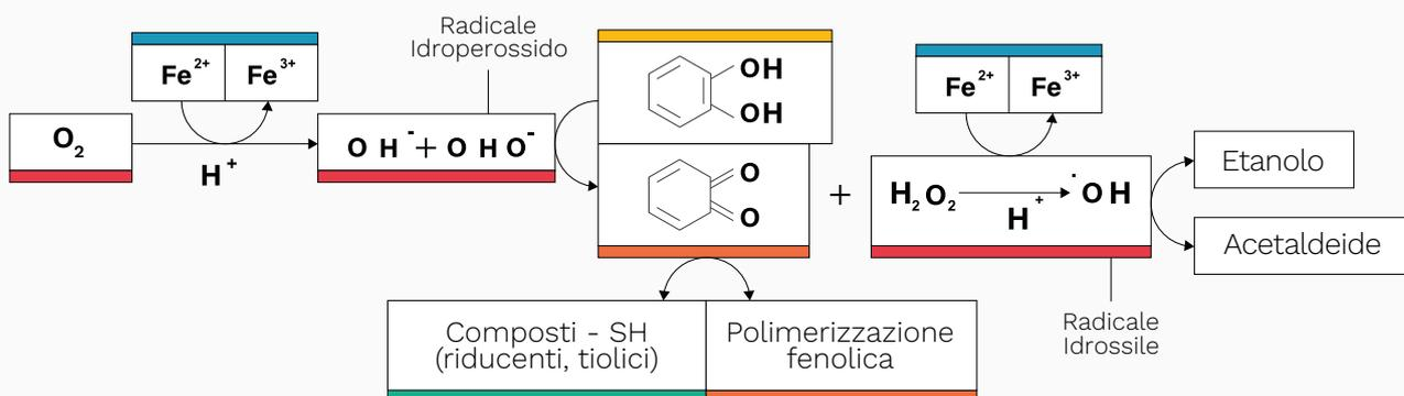
Processo di ossidazione chimica. Reazione di Fenton
