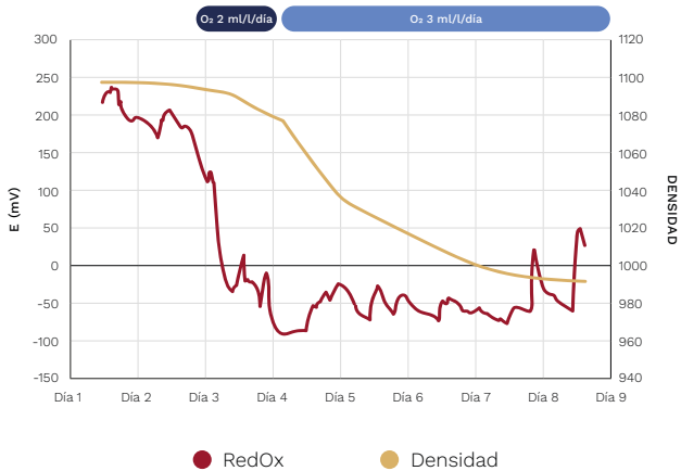
Monitorización del potencial electroquímico en fermentación con aporte de MOx. Variedad Tempranillo (DO Mancha).
