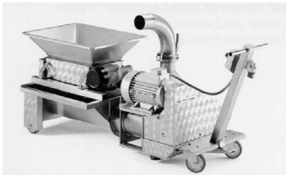
Estrujadora de dos rodillos de goma alimentaria, acanalados, colocados en la parte inferior de la máquina, con separación regulable que permite seleccionar el grado de pisado de la uva.
