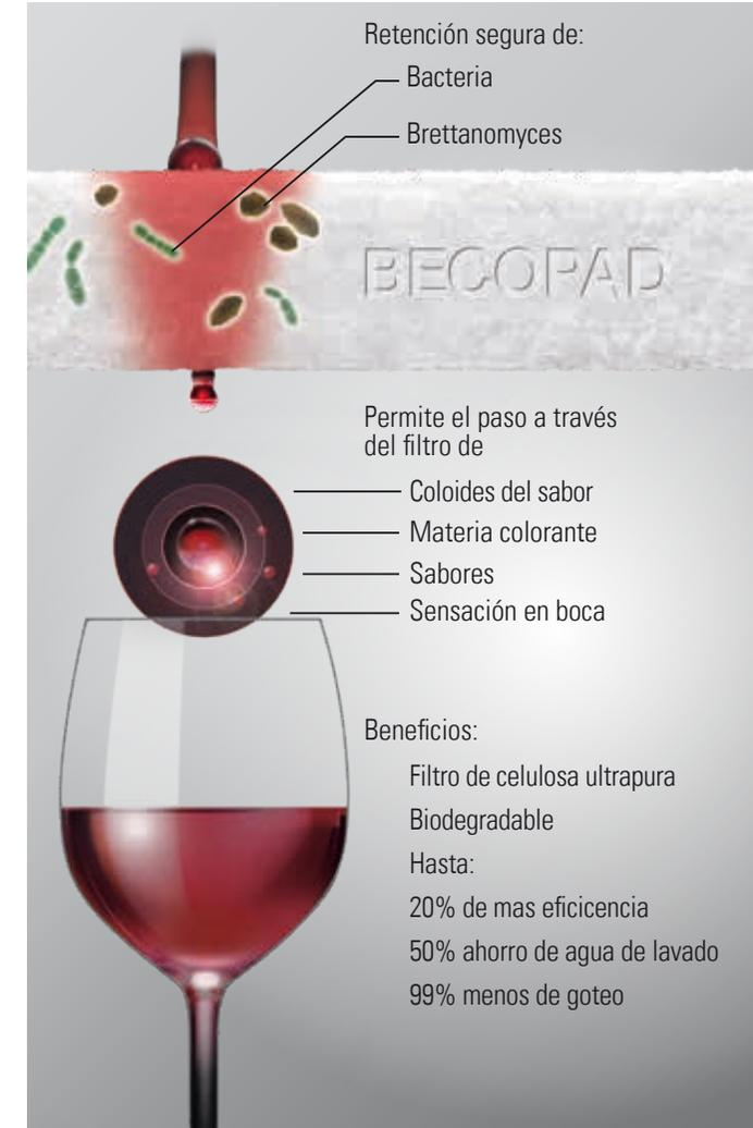
Una filtración clarificante con BECOPAD 450 reduce las levaduras Brettanomyces significativamente. Todos los medios filtrantes mas finas BECOPAD 350, BECOPAD 270, BECOPAD 220, BECOPAD 170 y BECOPAD 115C garantizan vinos libres de Brettanomyces.
